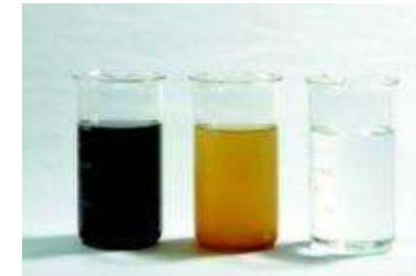
roest, kalkvorming en water uit circuits.
